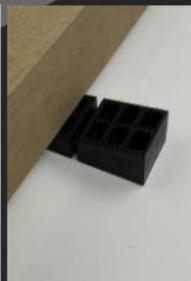
Todos sabemos que o chão nunca está plano... é sempre preciso nivelar a estrutura. A forma mais fácil é utilizar **calços**. Este calço permite compensar desníveis de 0 a 20mm, podendo ser separado em 3 peças, sobreponíveis. Com uma durabilidade muito superior a qualquer calço de madeira, esta é a solução mais prática para uma boa preparação da subestrutura.
